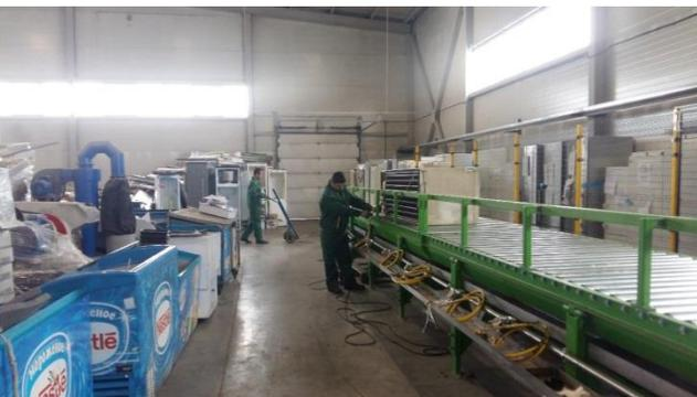
Роликовый конвейер осуществляет транспортировку холодильной и климатической техники к транспортеру с железными пластинами
