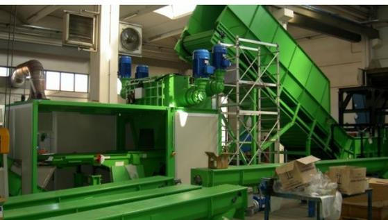
Первый шнековый конвейер предназначен для перемещения отходов к электромагнитному сепаратору
