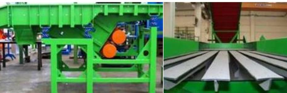
Вибрационный конвейер разделяет гранулы цветных металлов и пластика по разным линиям
