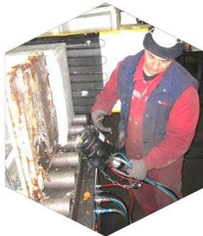
Система предназначена для извлечения фреоносодержащих газов и технического масла в отдельные емкости при помощи вакуума без выброса вредных веществ в атмосферу.
