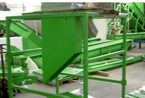
Магнитная сортировочная машина отсеивает неотделённые черные металлы, с целью их не попадания в гранулятор
