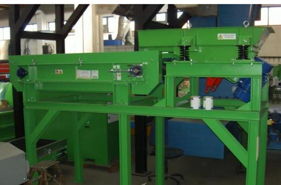
Вихретоковый конвейер путем воздействия на пластик электромагнитным воздействием, задерживает его на ленте, после чего вторсырье попадает на шнековый конвейер
