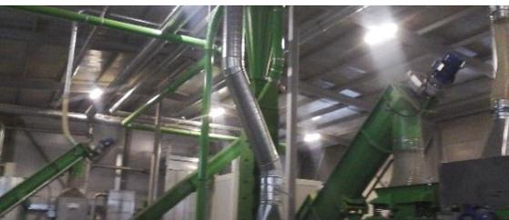
Эта система отделяет от сырья, выходящего из дробилки, мелкие фракции пены
