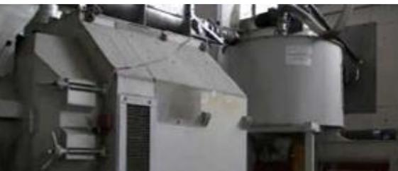
Пресс служит для уплотнения пены для ее более легкого хранения и транспортировки
